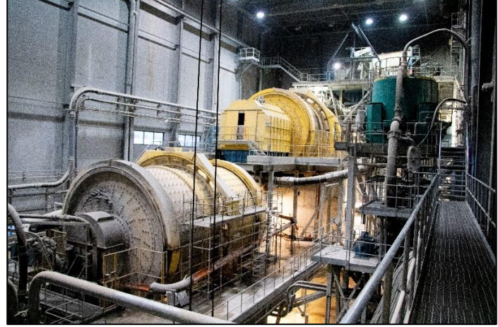
Kuva 2: AG- ja palamyly joissa kivi jauhetaan "hiekkaksi".
