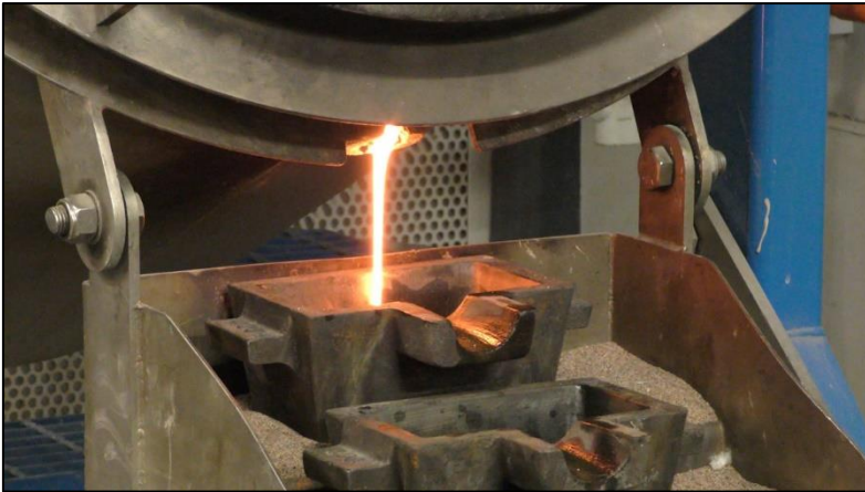
Kuva 3: Prosessin viimeinen vaihe eli kullan valu harkkoiksi. Yksi kultaharkko painaa noin 12kg.
